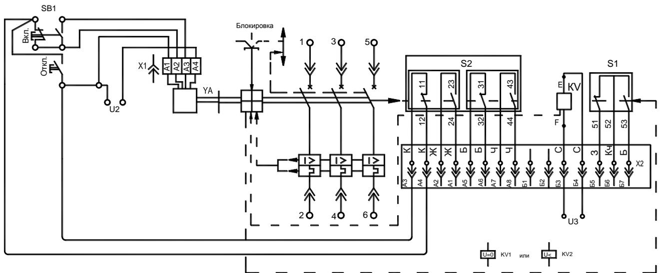
Рисунок Г7. Схема электрическая принципиальная выключателей выдвигного исполнения, с нулевым или минимальным расцепителем напряжения, вспомогательными контактами сигнализации автоматического отключения, вспомогательными контактами и электромагнитным приводом.
