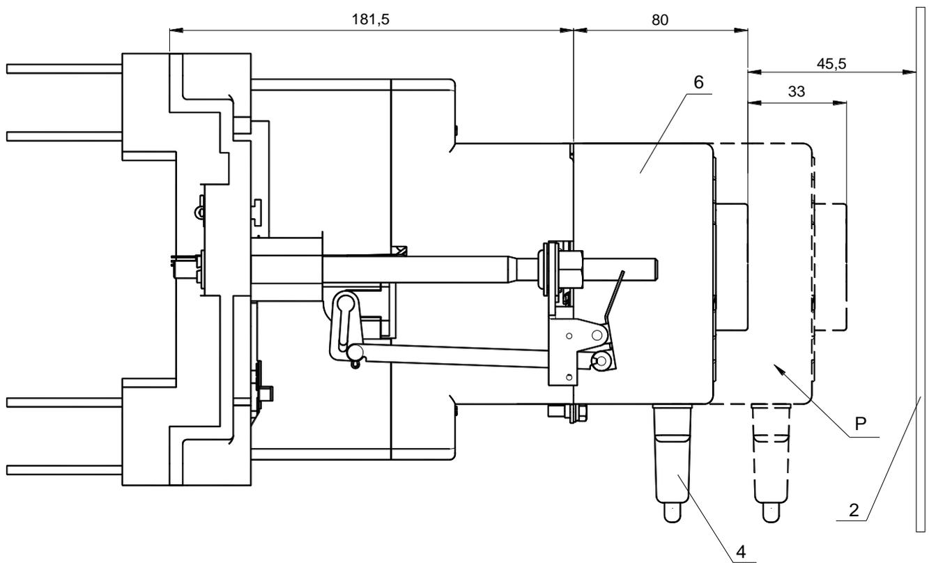
Рисунок Б8. Выключатель ВА57-35 выдвигного исполнения с электромагнитным приводом.
