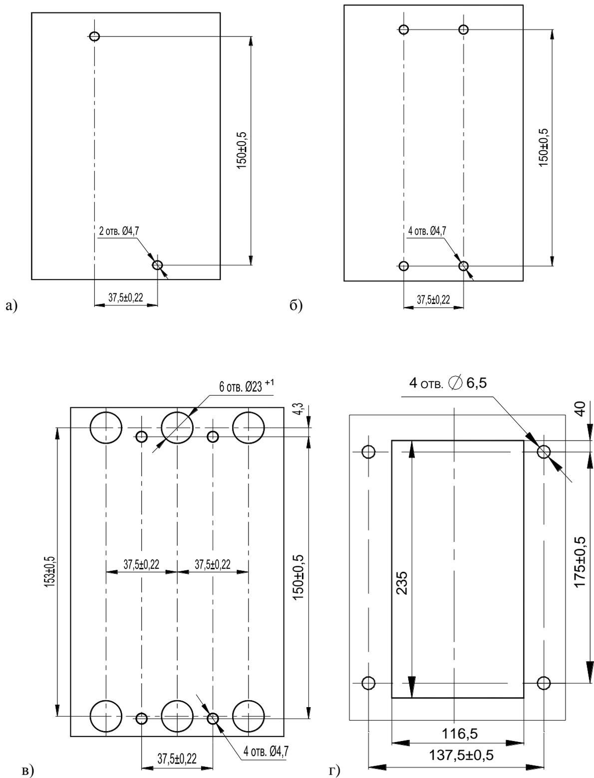
Рисунок Б4. – Расположение отверстий для крепления выключателя
