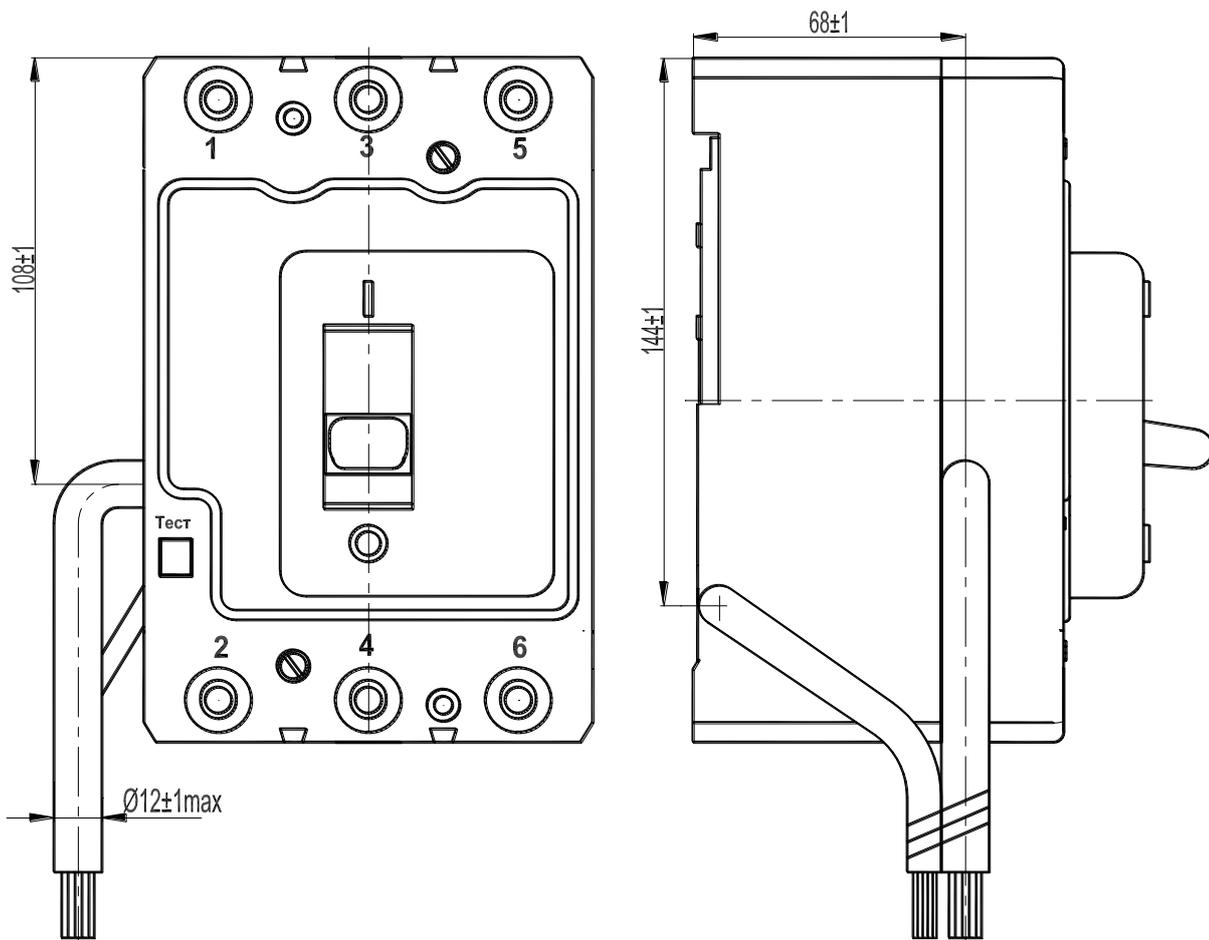
Рисунок Б9. Расположение выходящих из выключателя проводов от дополнительных сборочных единиц.
