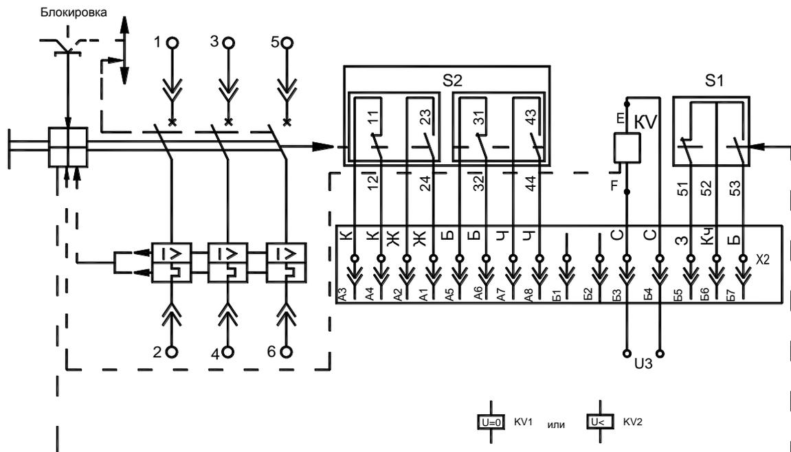
Рисунок Г8. Схема электрическая принципиальная выключателей выдвигного исполнения, с нулевым или минимальным расцепителем напряжения, вспомогательными контактами сигнализации автоматического отключения, вспомогательными контактами.
