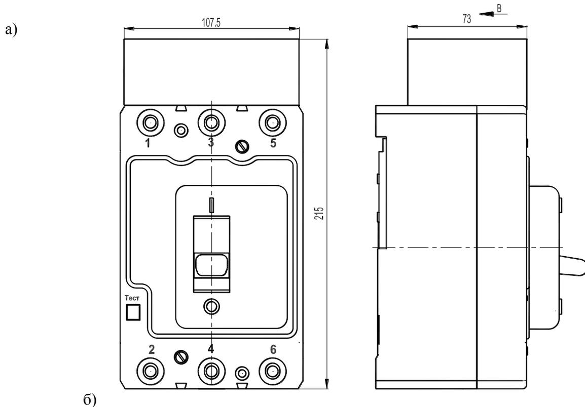
Рисунок Б1. Выключатель ВА57-35 (ВА57Ф35) с зажимами для переднего присоединения:
