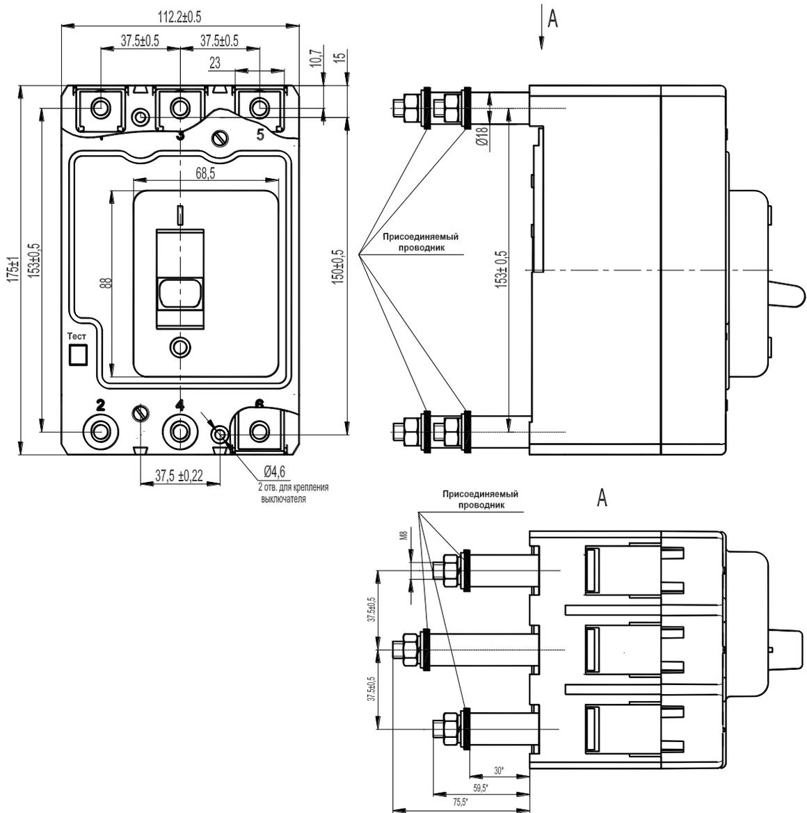
Рисунок Б2. Выключатели ВА57-35 (ВА57Ф35) с зажимами для заднего присоединения
