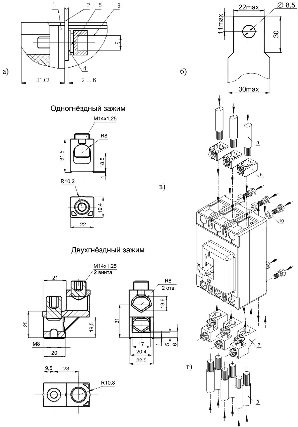
Рисунок Д1. Способы присоединения внешних проводников к выключателю:
