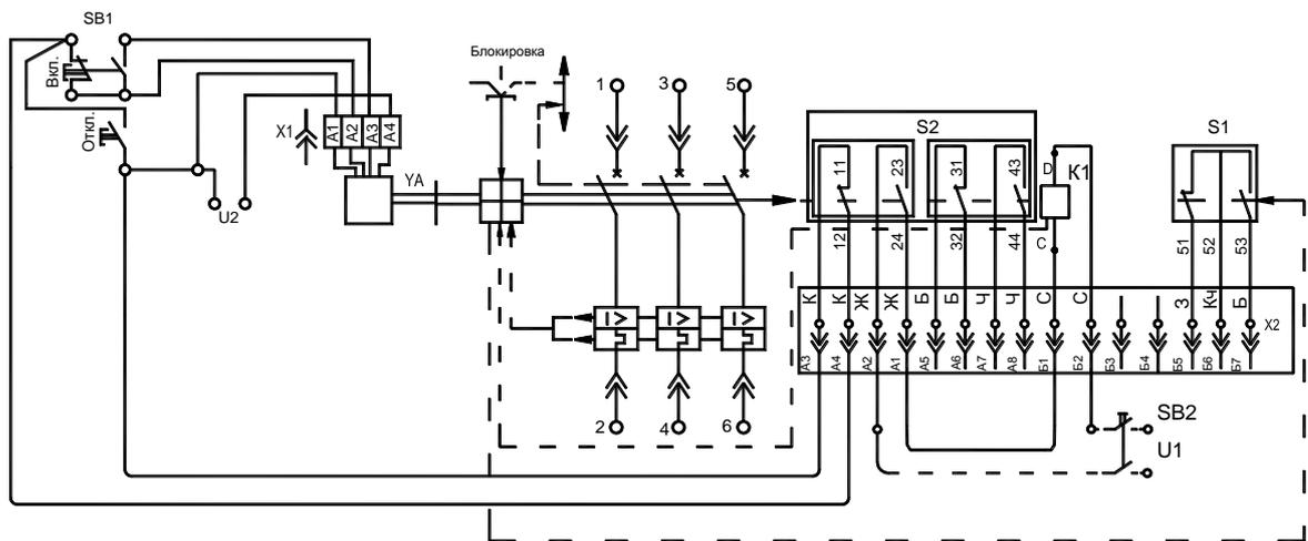
Рисунок Г5. Схема электрическая принципиальная выключателей выдвижного исполнения, с независимым расцепителем, вспомогательными контактами, вспомогательными контактами сигнализации автоматического отключения и электромагнитным приводом.
