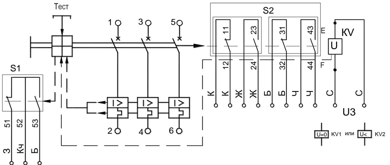
Рисунок Г3. Схема электрическая принципиальная выключателей стационарного исполнения, с нулевым или минимальным расцепителем напряжения, вспомогательными контактами сигнализации автоматического отключения и вспомогательными контактами.
