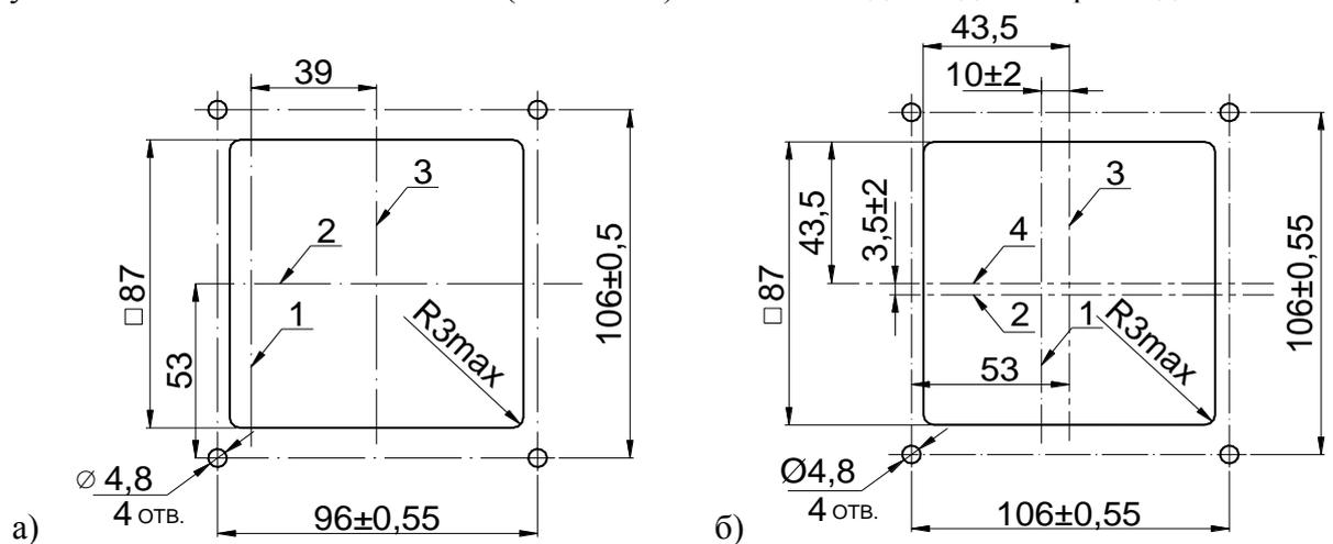
Рисунок Б3. Расположение отверстий для крепления ручного дистанционного привода
