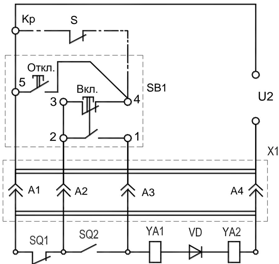
Рисунок Г9. Электрическая принципиальная схема привода электромагнитного.
