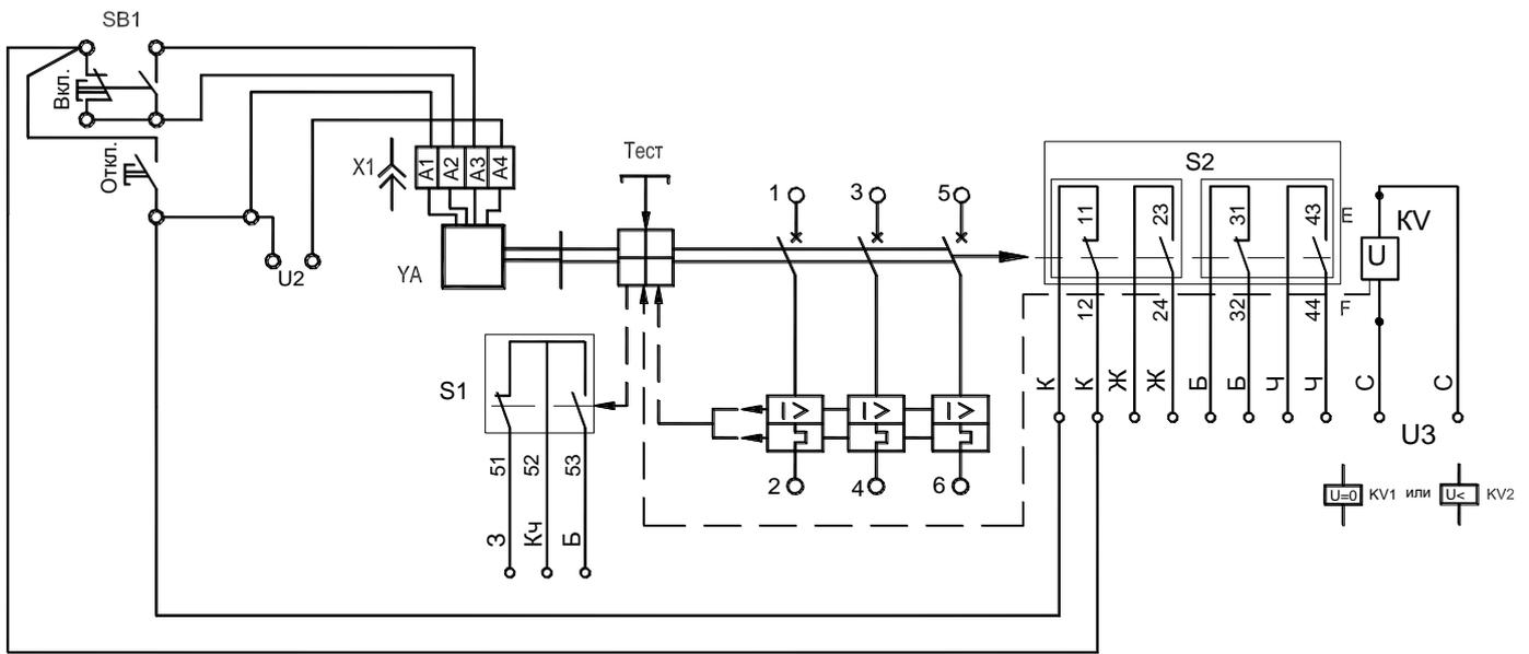
Рисунок Г4. Схема электрическая принципиальная выключателей стационарного исполнения, с нулевым или минимальным расцепителем напряжения, вспомогательными контактами сигнализации автоматического отключения, вспомогательными контактами и электромагнитным приводом.
