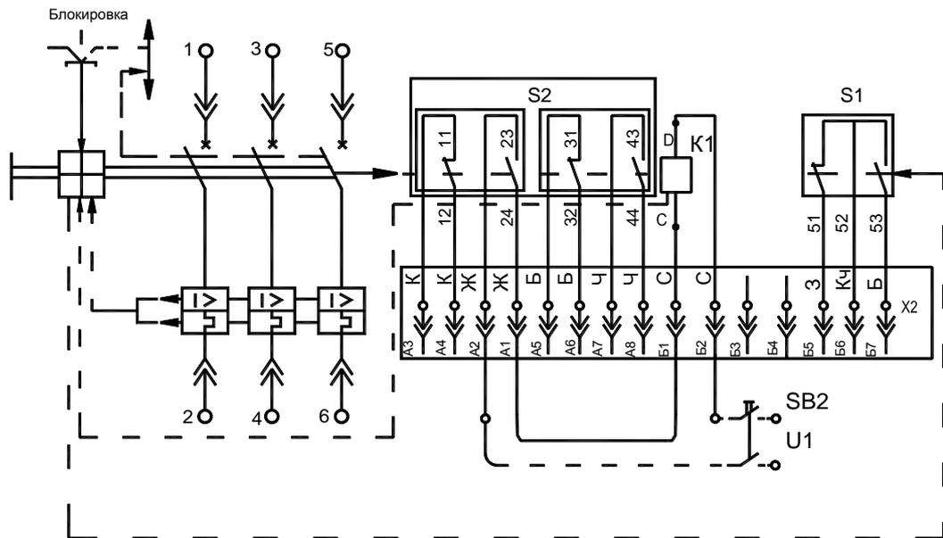
Рисунок Г6. Схема электрическая принципиальная выключателей выдвигного исполнения, с независимым расцепителем, вспомогательными контактами, вспомогательными контактами сигнализации автоматического отключения.
