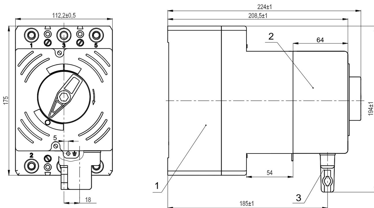
Рисунок Б6. Выключатель ВА57-35 (ВА57Ф35) с электромагнитным приводом.
