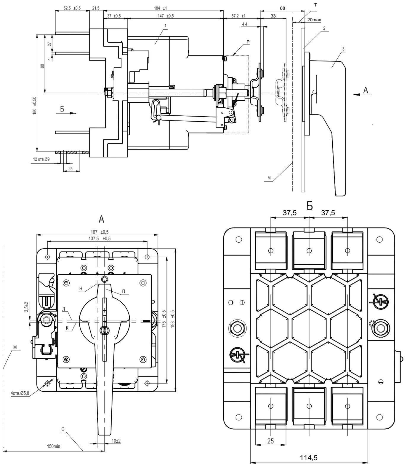
Рисунок Б7. Выключатель ВА57-35 выдвигного исполнения с ручным дистанционным приводом.
