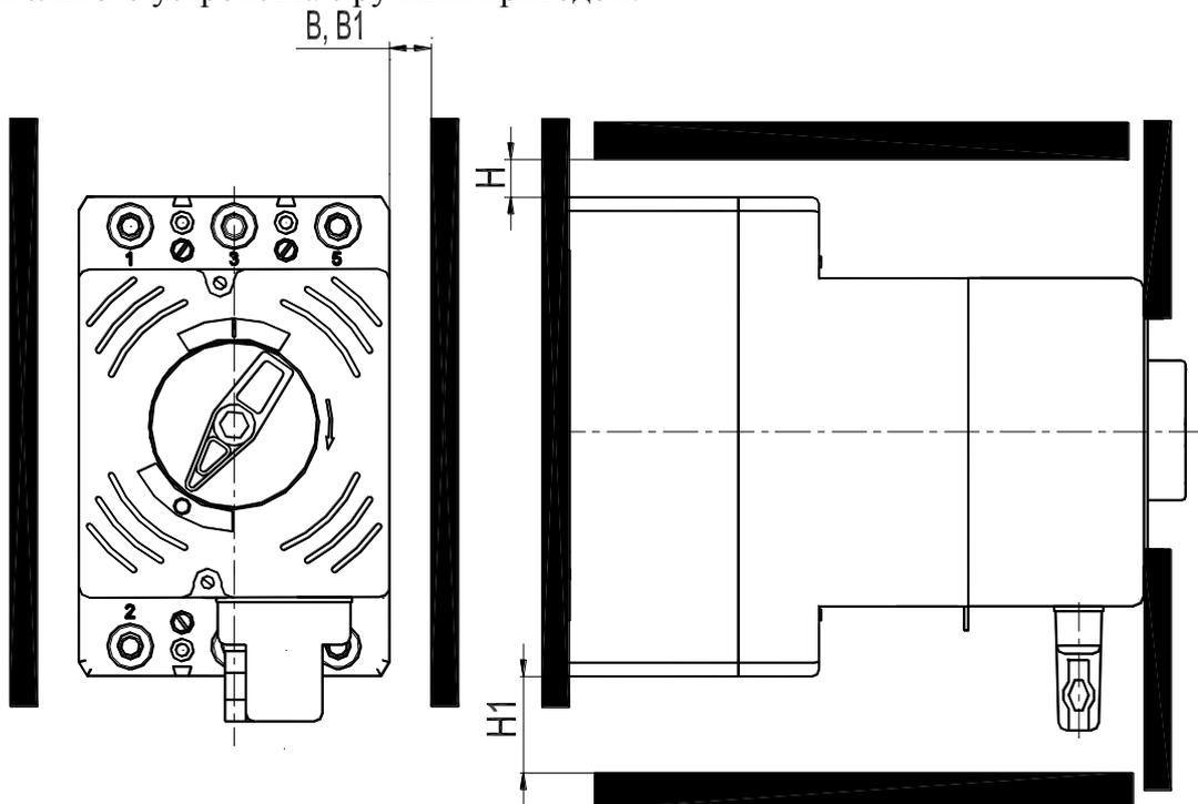
Рисунок В2 Минимально-допустимые расстояния от выключателя до металлических частей распределительного устройства выключателя с электромагнитным приводом.,3
