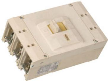
Выключатели ВА52-37 предназначены для проведения тока в нормальном режиме и отключения тока при коротких замыканиях, перегрузках и недопустимых снижениях напряжения, а также для нечастых (эпизодических до 6 раз в сутки) оперативных включений и отключений электрических цепей и рассчитаны для эксплуатации в электроустановках с номинальным напряжением до 440 В постоянного тока и напряжением до 660 В переменного тока частоты 50 и 60 Гц.
